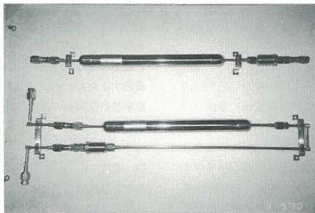
図1 インライン式精製器のI型とU型の外観
