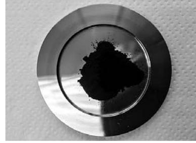
図 3 吸着セルと吸着材 (Maxsorb III)
