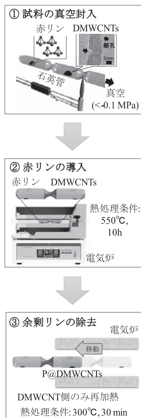
図3 DMWCNTs内部への赤リン昇華導入の手順
