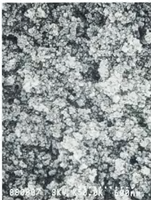
巨大網状構造の合成吸着剤の走査電子顕微鏡像 (×50,000)
