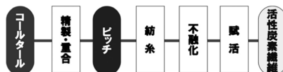
図2 ピッチ系ACFの製造工程
