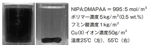
図9 NIPA-co-DMAPAA ポリマーのフミン酸の凝集沈殿分離(左:元の懸濁水溶液、右:自発的に生成した凝集体)
